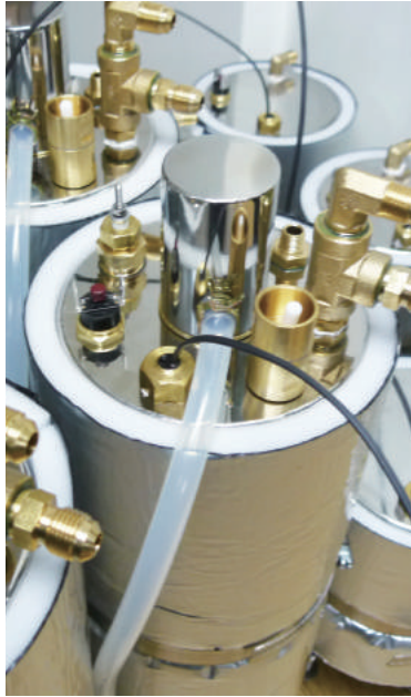
안전한 스테인리스 스틸 보일러와 히터(보일러 SUS 304, 히터 SUS 316)
